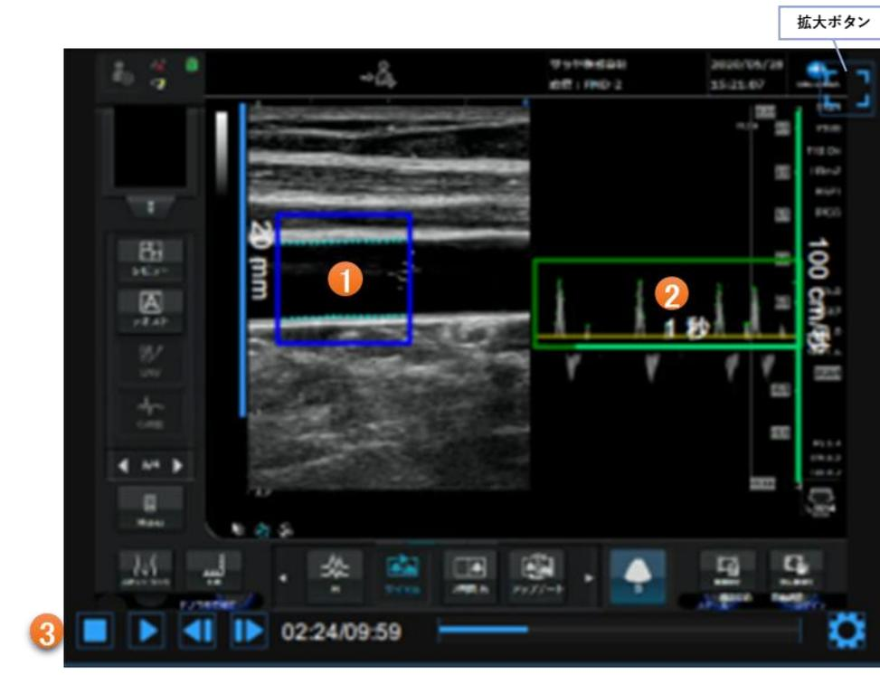
ビデオ画面には、超音波診断装置からのビデオ信号が表示されます。青色の血管径測定範囲①および緑色のドプラフローの計測範囲②を画面内に確認することができます。ビデオコントロールバー③は、画面の下部に配置されています。右上の拡大ボタンを押すと画面を拡大することができます。
