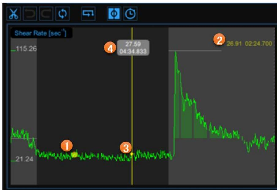
カーソルの座標は $s^{-1}$ 単位のせん断速度値と分・秒・ミリ秒形式で表示し、②に示します。カーソルボタンがアクティブなとき、グラフ内の正確な点の座標が表示され、チャート上で移動することだけが必要であり、第2の③のカーソルが表示されます。
