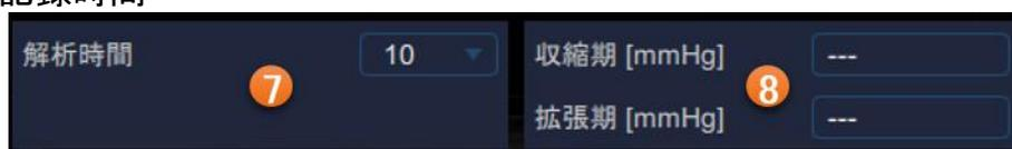
設定パネルの⑦の項目は、血管径およびIMTデータの解析時間を示しています。
