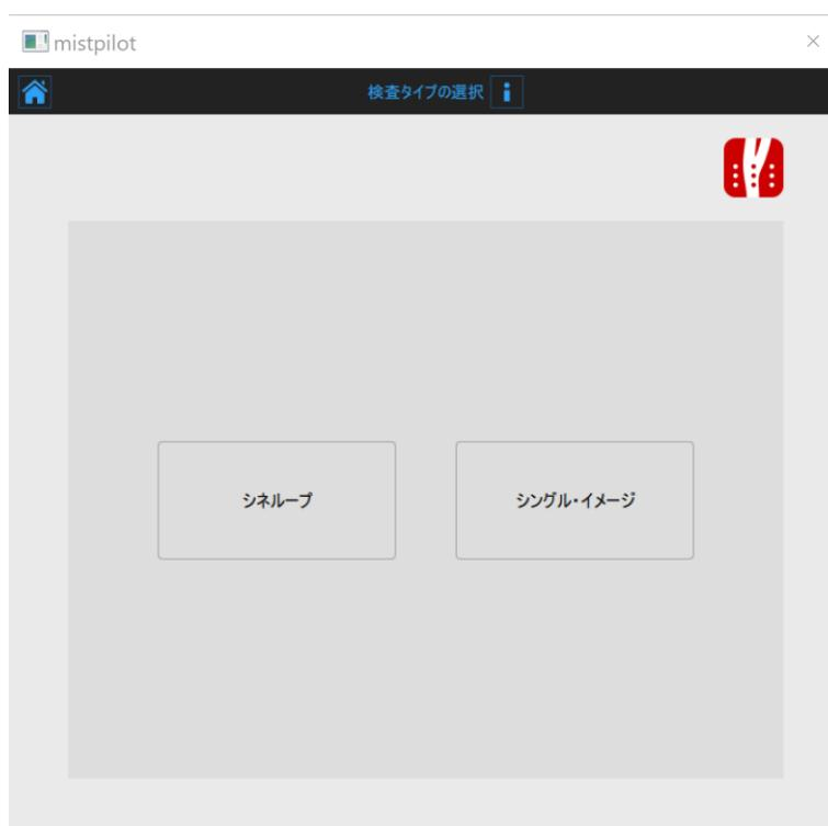
この画面では、検査形式を選択することができます。IMT測定では、シネループ形式(ビデオクリップの読み込み)とシングル・イメージ形式(ビデオからのフレームの処理、または画像として読み込まれたフレームの処理)を通じて解析することができます。
