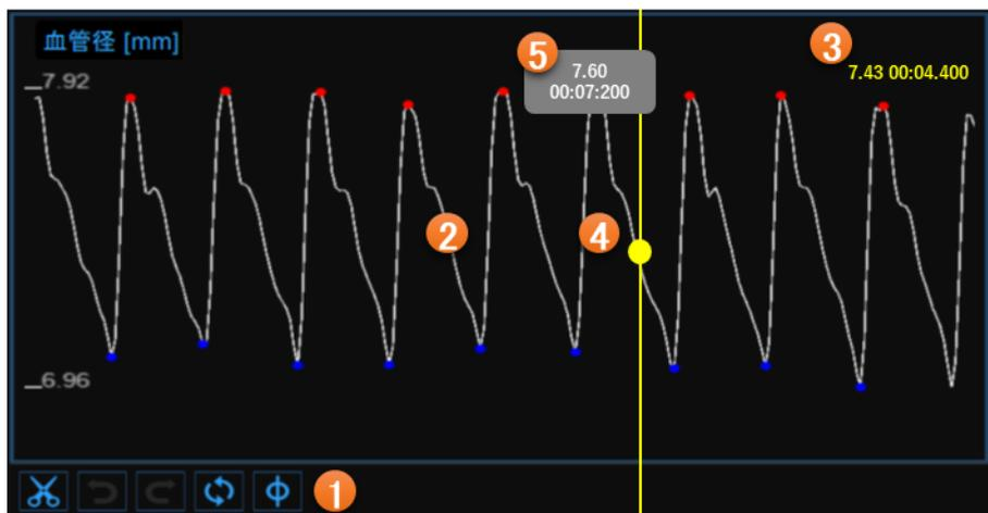
上図に示すように、①のカーソルボタンは、ビデオ画面に表示された画像に応じたグラフ上の現在時刻位置を示す血管径チャート上の②のカーソルを有効にします。カーソルの座標(ミリメートル単位の血管径値および分・秒・ミリ秒形式の時間値)は、動的に更新され、③に示されます。カーソルボタンがアクティブのとき、グラフ内の正確な点の座標を知ることが可能であり、チャートにカーソルを合わせることが必要とされ、第2のカーソル④が表示されます。それはマウスの動きに従い、点の正確な座標がラベル⑤に示され、血管径値はミリメートルで表され、時間値は分・秒・ミリ秒で示されます。
