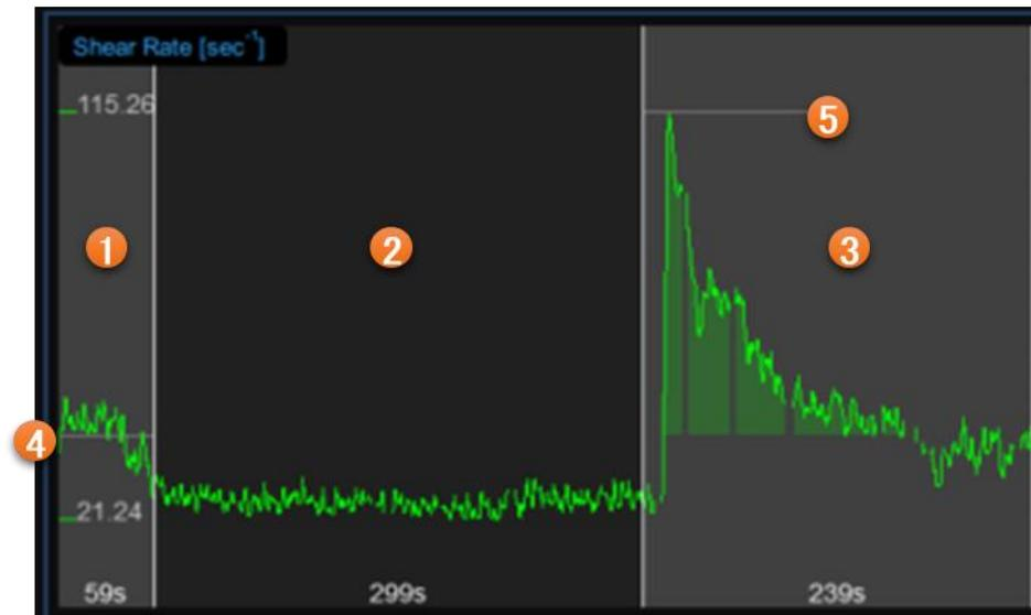
チャートは、検査中の正の時間平均せん断速度の推移を示します。
