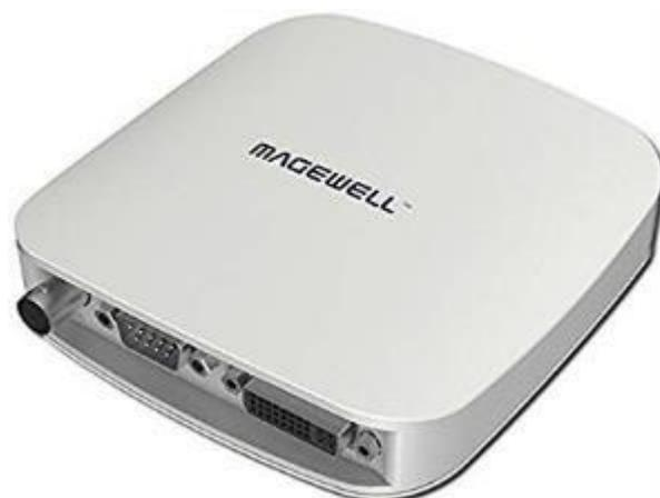
超音波診断装置をUSB Capture AIO に接続後、USB ケーブルを介してコンピュータをビデオコンバータに接続します。赤色のLED (PWR) は、装置の電源が入っていることを示します。緑色のLED (ACT) は、装置のステータスを示します。
