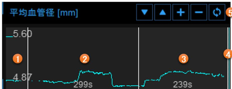
チャートは、検査形式に従って、3つまたは2つの部分に分割されます。FMDでは、①の安静時間、②の駆血時間および③の血管拡張時間があり、血管拡張形式では駆血時間の設定はされません。オフラインモードでは、ビデオの時間が安静時間+(駆血時間)+血管拡張時間の合計よりも大きい場合、④の部分が存在することがあります。
